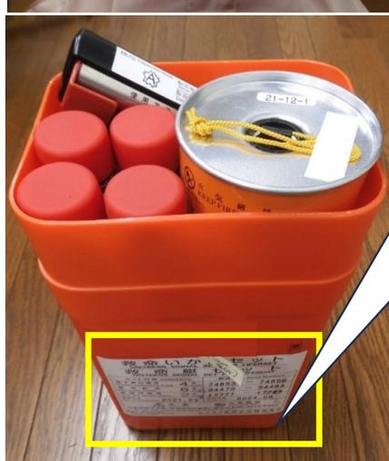
⑦ ラベルに信号紅炎、発煙浮信号の製造年月・失効年月、製造番号を記入した後、収納ケースにAパックのラベルを貼り付けます。
